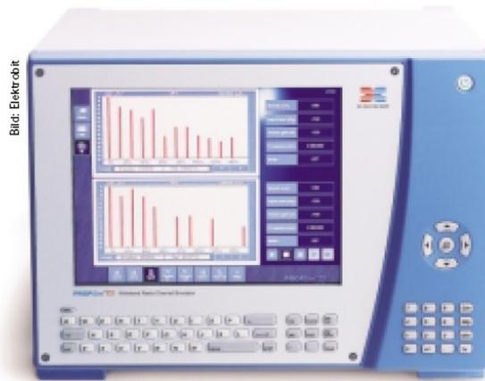
**Der Funkkanalsimulator Prop Sim C2 von Elektrobit arbeitet mit vorgefertigten und selbst definierten Kanalmodellen oder verarbeitet die mit dem Prop Sound vor Ort gemessenen Daten für die Simulation**
