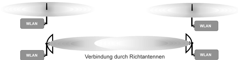
Bild 15.3: Veranschaulichung von Omnidirektional- und Richtantennenwirkung
